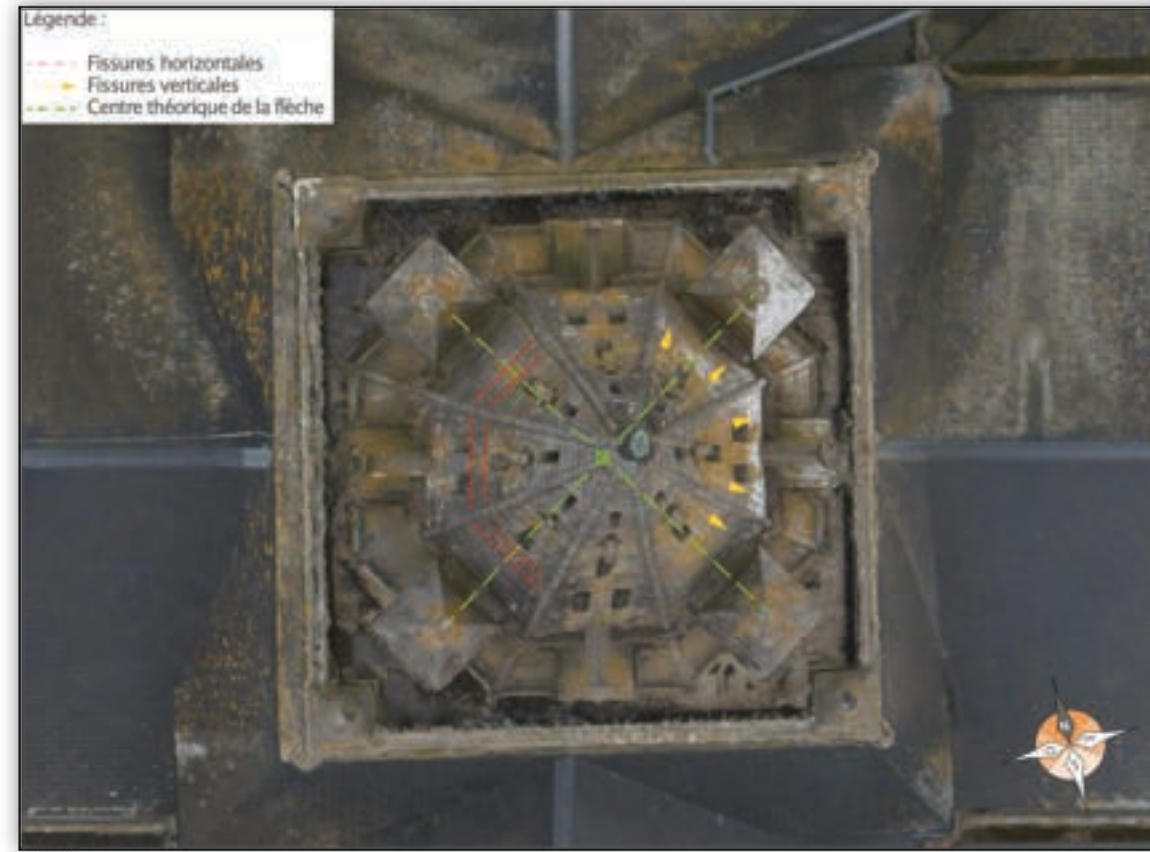
Analyse de la statique de l'ouvrage par photogrammétrie.
