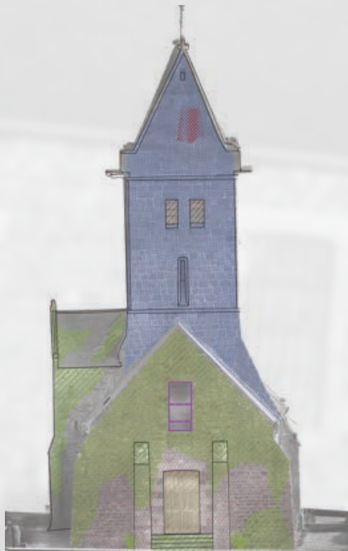
Extrait du plan de repérage des pathologies de la façade Ouest.
